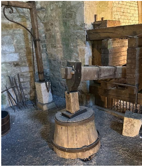
historische Schmiede mit dem mittels Wasserkraft
